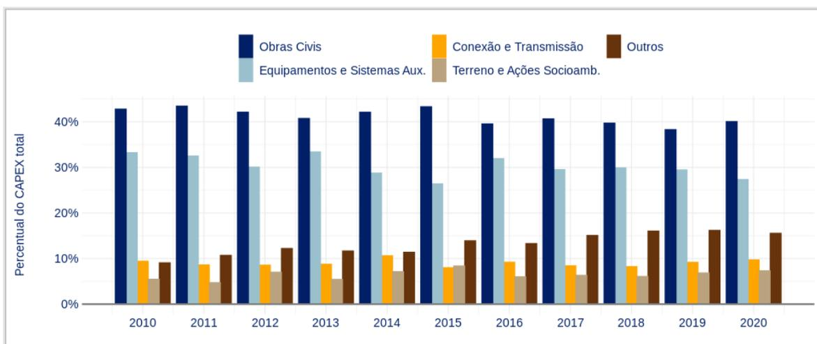
Figura 35: Estratificação dos valores de CAPEX de projetos de PCH e CGH
